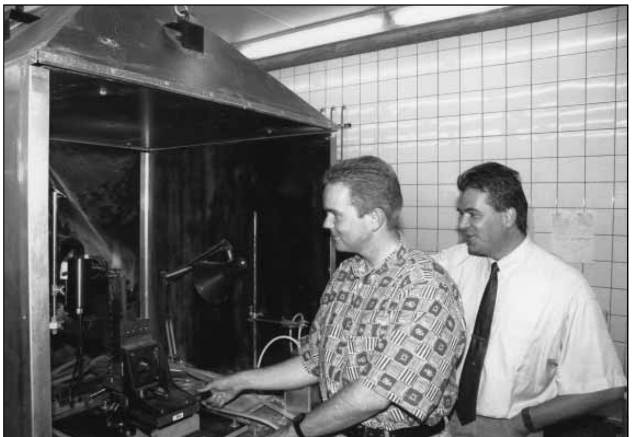
Promovendus ir. Roel Mallens (links) en dr. Philip de Goey bij een laser-doppler opstelling voor snelheidsmeting bij vlammen. Foto: Stan Olieslagers/Dekate Mousa
