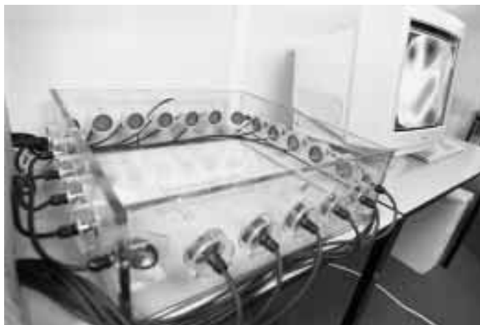
Deze simulatie van een kas geeft weer hoe het meetsysteem werkt. Door geluid te verzenden en weer op te vangen wordt informatie verkregen over temperatuur en luchtvochtigheid. Foto Bart van Overbeke
