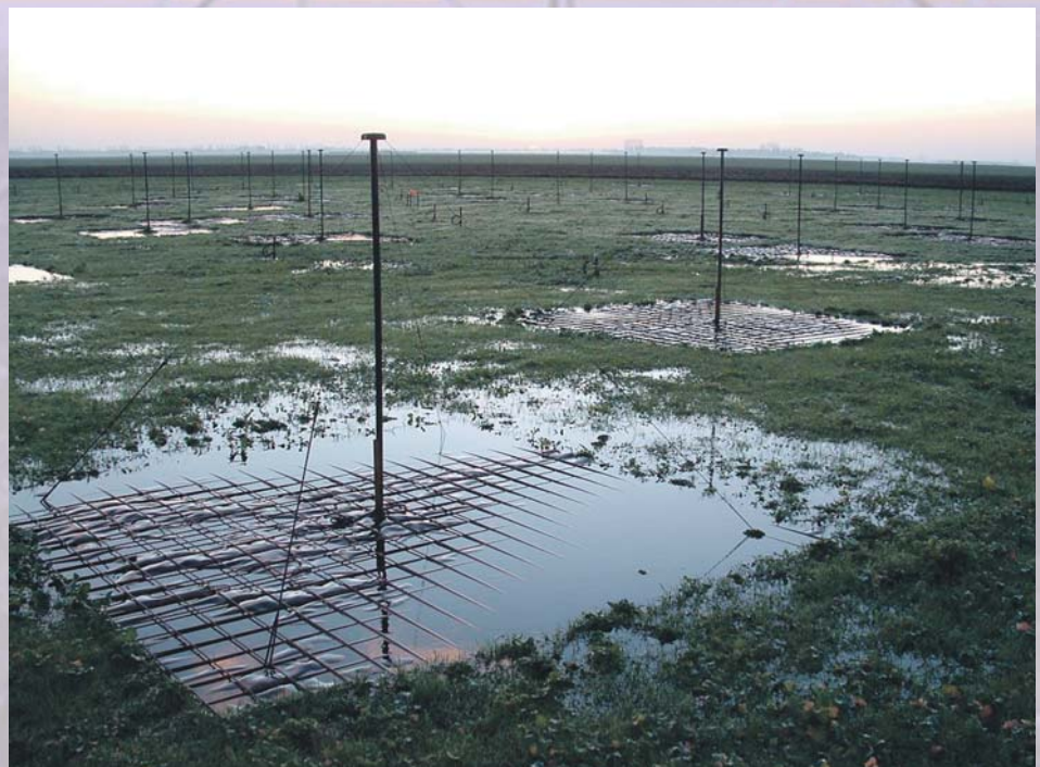
Een LOFAR-veld met 'low band' antennes.
